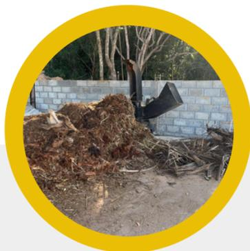
Os materiais de poda e jardinagem são triturados para diminuir a granulometria do material para servir de material estruturante e fonte de carbono no processo de compostagem
