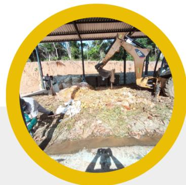
Os materiais estruturantes são misturados com os restos de alimentos segregados visando a montagem das leiras em proporção adequada para o processo da compostagem
