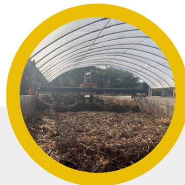
Essa mistura é disposta nas leiras onde são revolvidos com equipamento automatizado e são monitorados diariamente os parâmetros como Ph, temperatura e umidade
